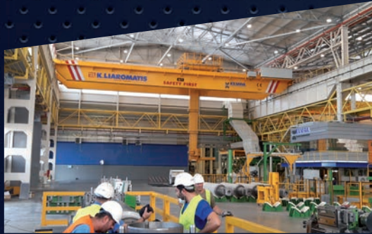
Επικαθήμενη Γερανογέφυρα Διπλού Φορέα 32/15tn x 41.4m με ανυψωτικό εξοπλισμό Verlinde. Πελάτης: Elval 2022, Οινόφυτα Βοιωτίας
