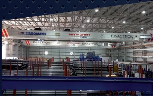
Επικαθήμενες Γερανογέφυρες 2 τμχ Διπλού Φορέα 12tn x 30.8m & 12.5tn x 31m & 2τμχ 8tn x 30.8m με ανυψωτικό εξοπλισμό Verlinde. Πελάτης: Elastron 2022, Ασπρόπυργος, Δυτική Αττική
