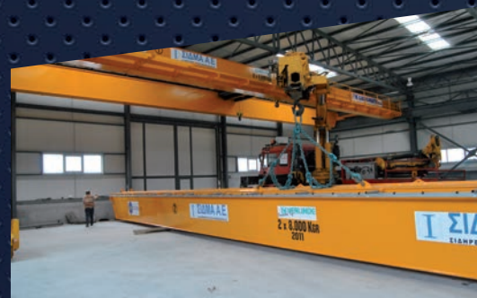
Επικαθήμενες Γερανογέφυρες 2τμχ Διπλού Φορέα 8tn x 29m με ανυψωτικό εξοπλισμό Verlinde. Πελάτης: Sidma Steel 2011, Οινόφυτα Βοιωτίας
